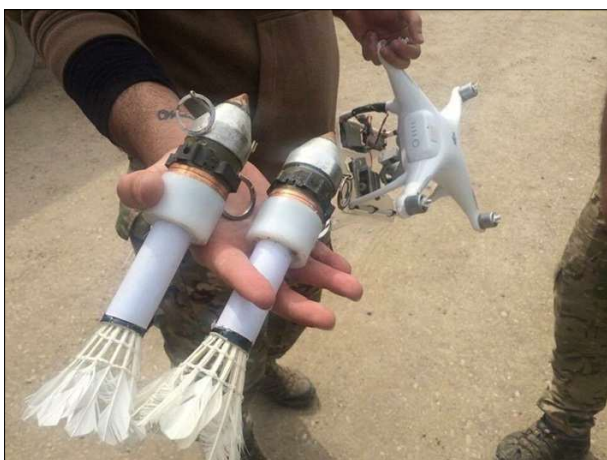
Ph. 4 – Soldat irakien tenant dans la main gauche un drone Phantom (sans ses hélices), et dans la main droite les deux grenades artisanales qu'il transportait.
