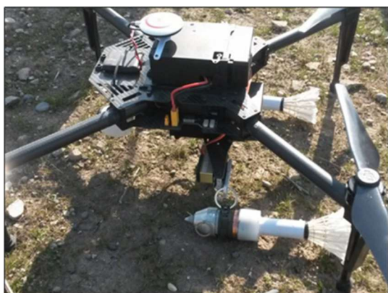
Ph. 2 – Drone de Daesh neutralisé lors de la bataille de Mossoul. Noter les deux grenades artisanales prêtes à être larguées.
